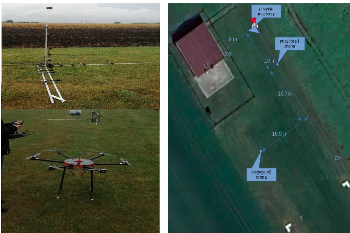
Rys. 3a Macierz mikrofonów (góra), dron numer 2 (dół). 3b Pomiary, trawiaste lotnisko pod Wrocławiem .
