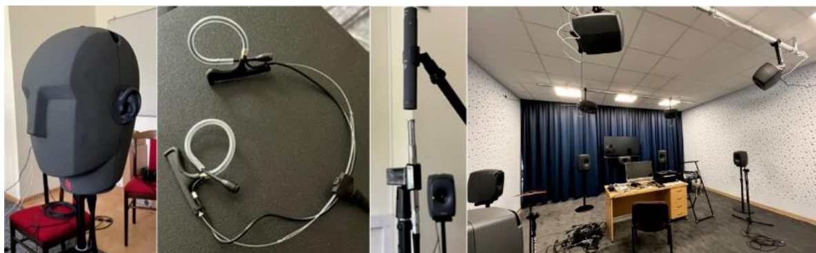
Rys.2. Sztuczna głowa, mikrofony binauralne, sonda natężeniowa i laboratorium dźwięku immersyjnego z systemem głośnikowym 7.1.4.
